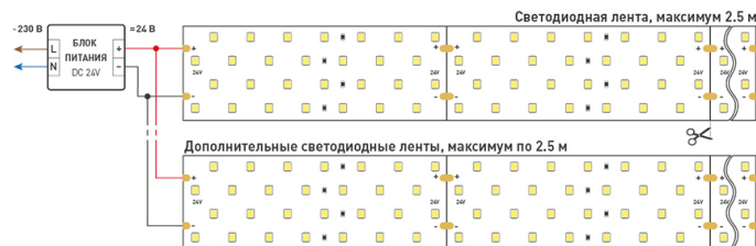
Схема 1. Подключение нескольких светодиодных лент с одной стороны.
