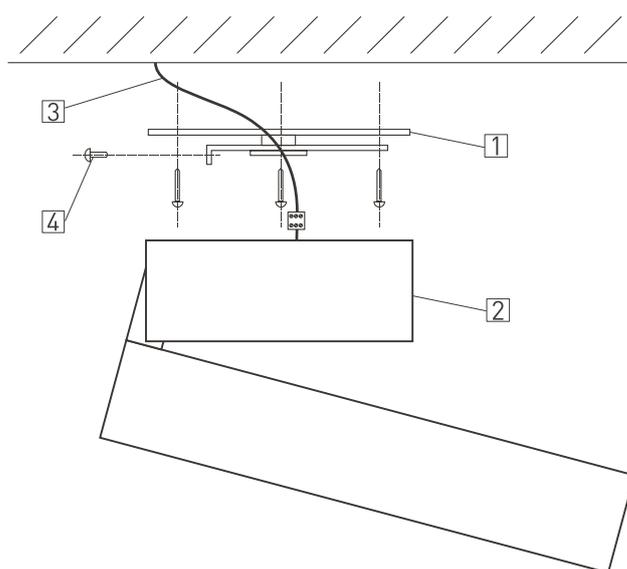
Рис. 1. Установка и подключение светильника.
